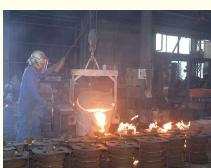
造型した砂の型に、どろどろに溶けた高温の鉄を流し込んで製品の形を作ります。その後、鉄が冷めるまで待ちます。
