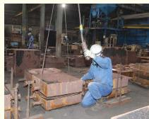
溶けた鉄を入れるための型を作る仕事です。圧力を加える専用の機械を使い、粘土や薬品で砂を固め、製品の形にします。
