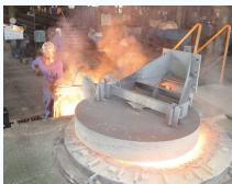
大きななべのような「溶解炉」に鉄のスクラップを入れ、1500℃の高い温度で溶かします。製品をがんじょうにするため、成分(材料)を調整します。
