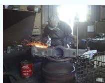
冷えて固まった製品を型から取り出し、砂などの汚れを取り除きます。検査をして荷造りをし、お客様のもとへ送ります。
